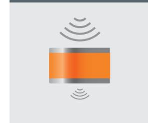
Schallwellen sind mechanische Schwingungen, die durch starre Verbindungen von einem Körper auf den anderen übertragen werden können (Körperschall). Naturkautschuk (NR) bzw. Elastomere sind sehr effektive Werkstoffe die den Körperschall sehr gut isolieren können.
