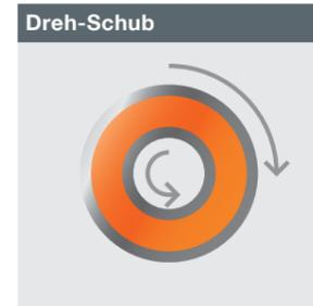
Gummi-Metall-Buchsen eignen sich zur elastischen Aufnahme von Drehmomenten. Durch das Verdrehen der Metallhülse entsteht eine Schubbelastung im Elastomer-Federkern. Die Querschnittsgröße des Federkerns bestimmt die Verdrehsteifigkeit der Gummi-Metall-Buchse.
