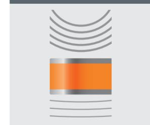
Durch eine Schock- oder Stoßeinwirkung werden die Schwing- bzw. Lagerelemente kurzzeitig mit hoher kinetischer Energie beaufschlagt. Diese Energie wird in der Federarbeit umgesetzt. Die maximale Energie darf 2 bis 2,5 mal so groß wie bei der statisch zulässigen Beanspruchung liegen. Die Federkurve und die Fläche bestimmen die maximale Energieaufnahme von Schwing- bzw. Lagerelementen.
